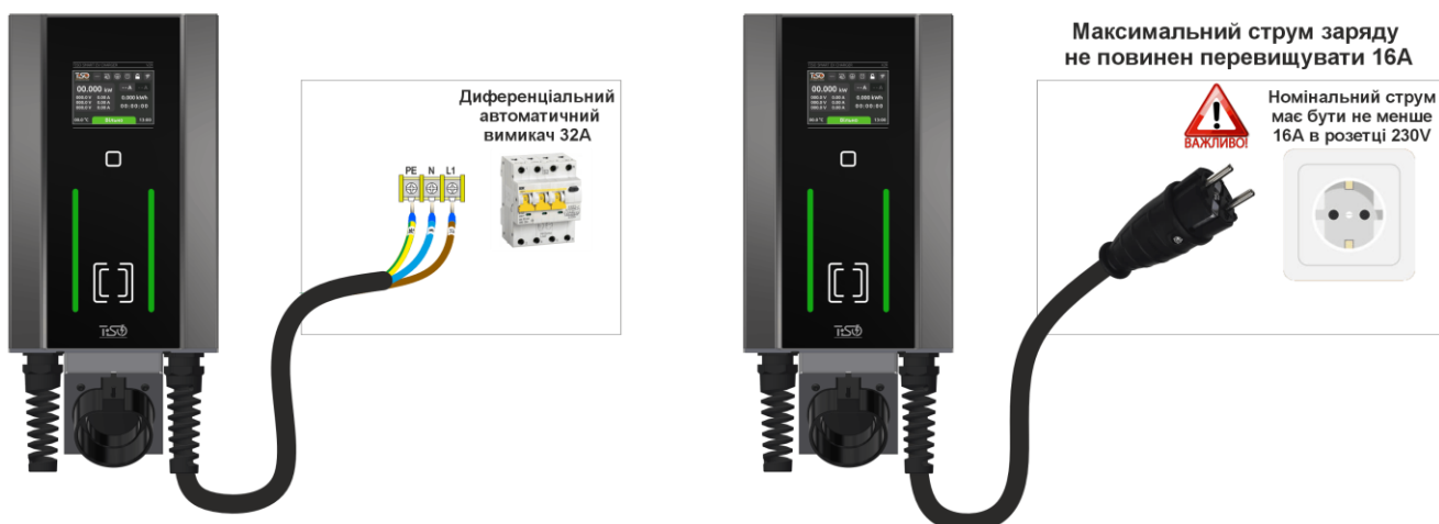
Рис. 8 – Варіанти підключення однофазної ЗС
