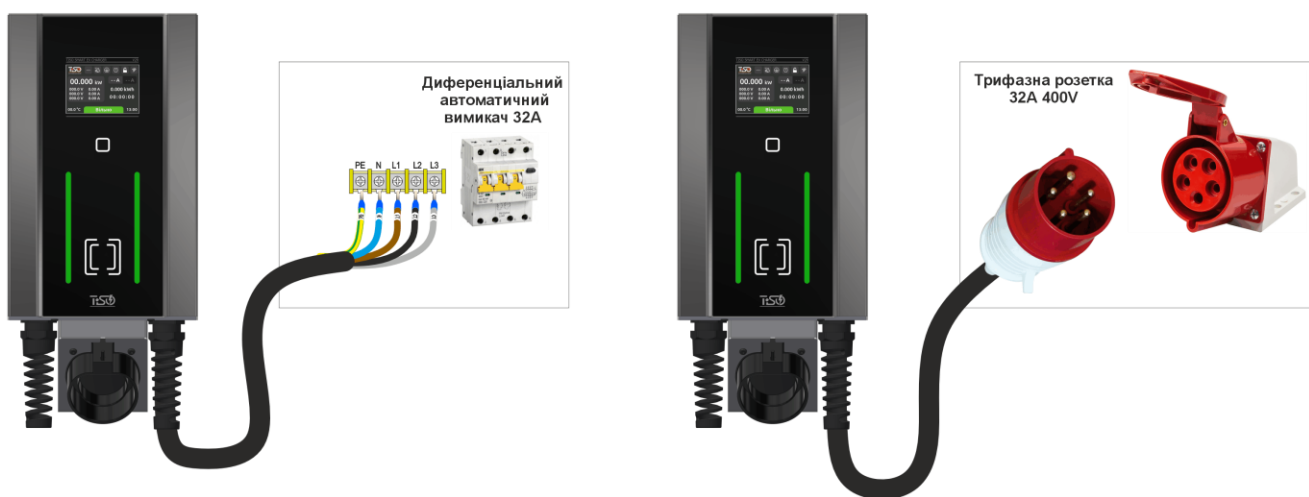
Рис. 9 – Варіанти підключення трьохфазної ЗС
